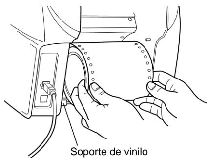
4. Pase el rollo de cinta por debajo de la palanca de eliminación de polvo (plateada).
